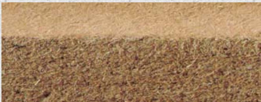
Le fibre di legno in sospensione in 98% di acqua formano un impasto fibroso che verrà pressato in pannelli.
